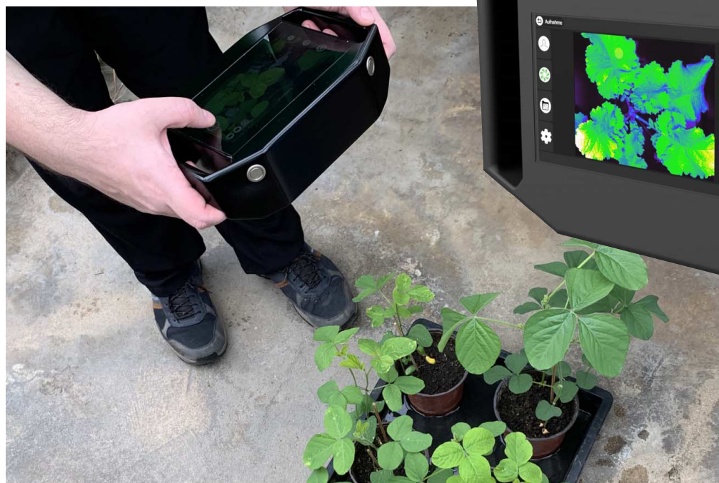
Bild 1 | Die Handheld Kamera BlackMobile bietet eine Kombination aus 4K-RGB & HSI-Sensor und verfügt über eine integrierte Breitband-LED-Beleuchtung, die den spektralen Messbereich der Kamera von 500 bis 1.000nm abdeckt.
